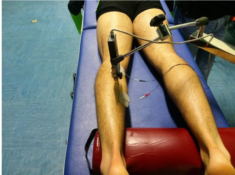
Slika 3: Postavitev senzorja in elektrod pri TMG meritvi mečnih mišic (gastrocnemius) leve noge (vir: Marinšek, 2014)
